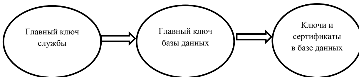
Рисунок 1 – Иерархическая цепочка ключей алгоритма TDE
