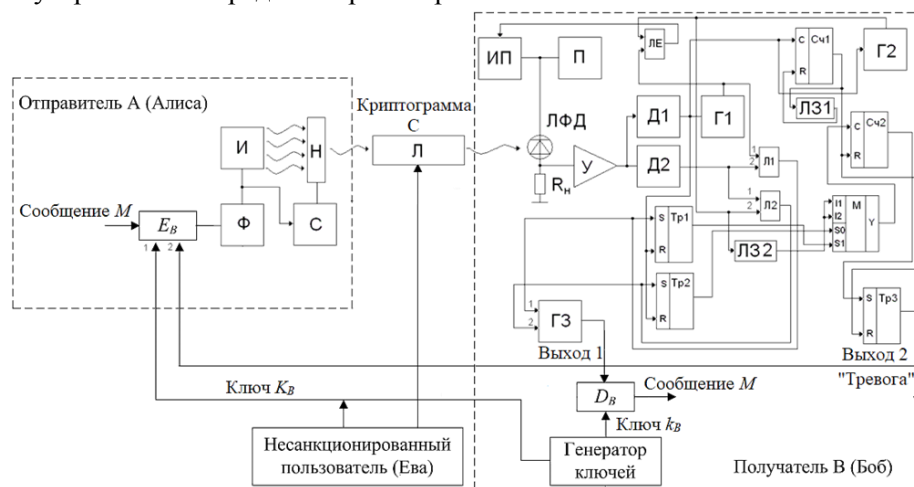
Рисунок 1 – Структурная схема двухключевой криптографической системы связи с возможностью обнаружения несанкционированного пользователя
