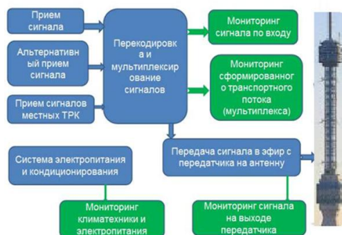
Рисунок 1 – Блок-схема работы цифрового ТВ-вещания
