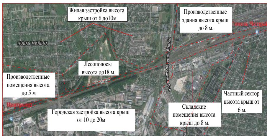
Рисунок 1 – Рельеф радиотрассы Центролит – Гомель-Четный
