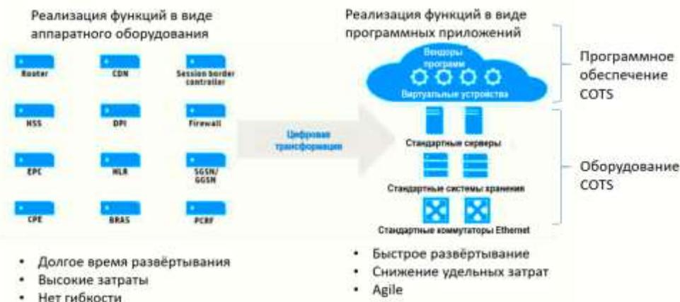
Рисунок 1 – Переход к виртуальной платформе SDN/NFV в 5G
