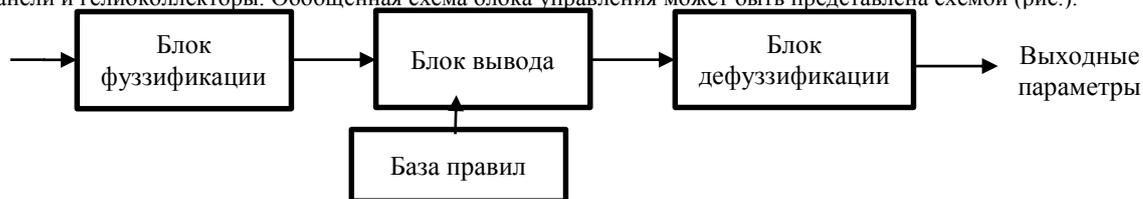
Рисунок – Обобщенная схема структуры блока управления
