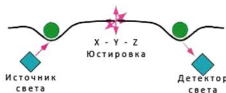
Рис. 4. Метод юстировки по максимальному уровню мощности сигнала
