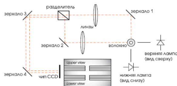
Рис. 7. Схема регистрации тепловых изображений
