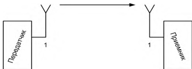
Рисунок 1б – Принцип SISO
