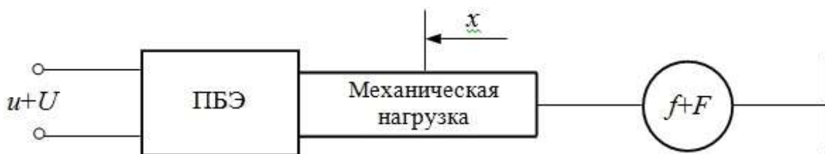
Рисунок 1 – Обобщенная схема пьезоэлектрического биморфного преобразователя: ПБЭ - пьезоэлектрический биморфный элемент; МН – механическая нагрузка
