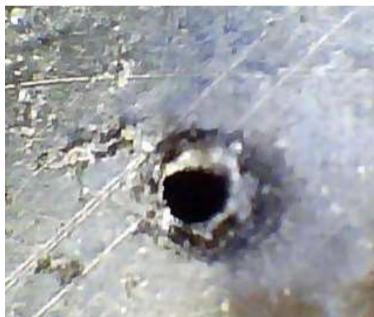
Рисунок 2 – Внешний вид кратера на поверхности нанопленки после воздействия серии лазерных импульсов
