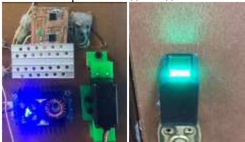
Рисунок 1 – CC3000 оптический сенсор отпечатков пальцев установленная в дверь
